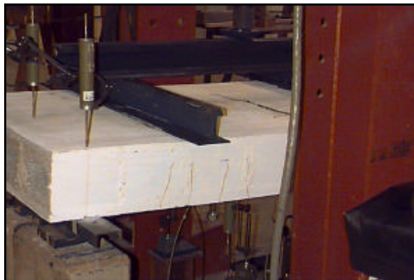
Figura 7.7 – Ruptura da parede P04.
