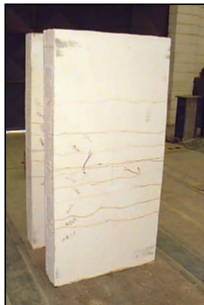
Figura 7.2 - Configuração final de fissuras da parede P02.
