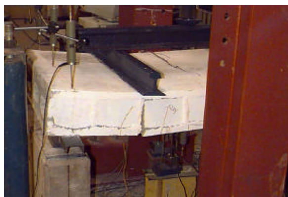
Figura 7.8 – Seccionamento de toda a fiada de blocos na ruptura da parede P04.
