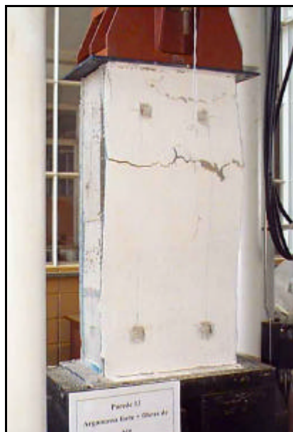
Figura 5.19 – Ruptura da parede P13
