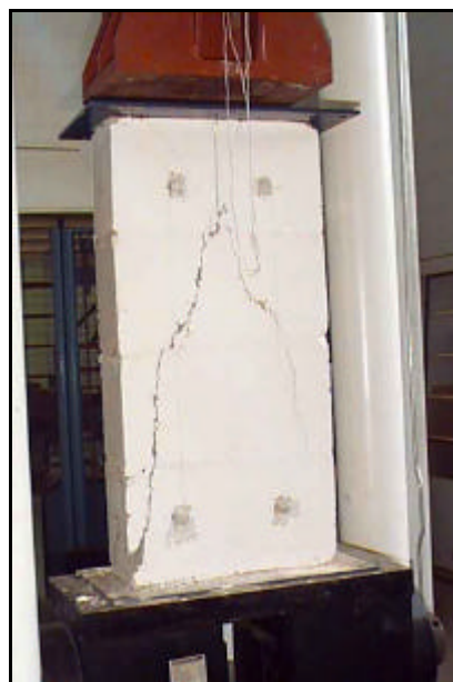
Figura 5.2 - Ruptura da parede P02.
