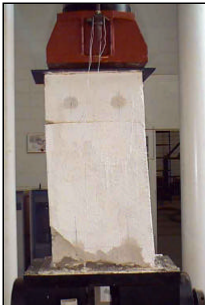
Figura 5.4 - Destacamento da 1ª fiada.
