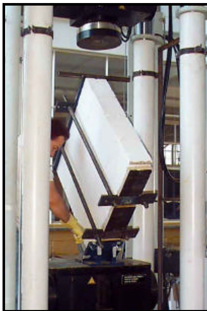
Figura 4.23 - Colocação de massa plástica na sapata de apoio.
