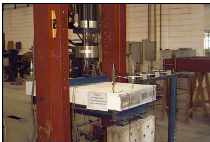
Figura 4.27 - Ensaio com carga aplicada no vão.
