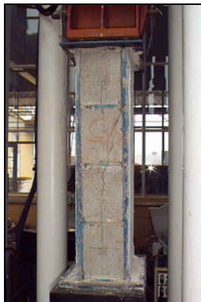
Figura 5.11 - Ruptura dos septos dos blocos da parede P08.
