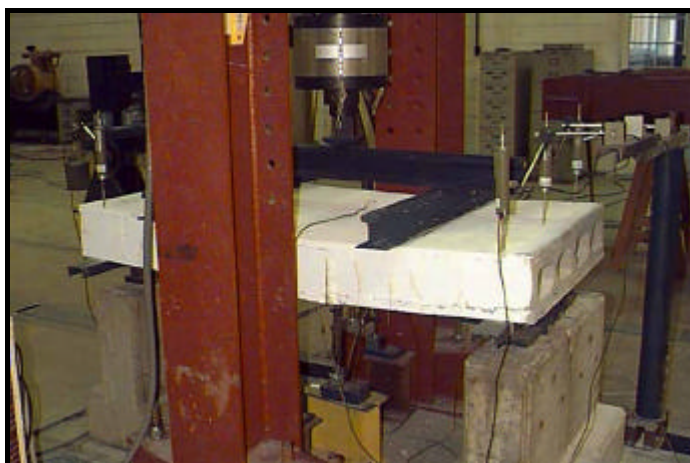
Figura 4.28 - Ensaio com carga aplicada nos terços do vão.
