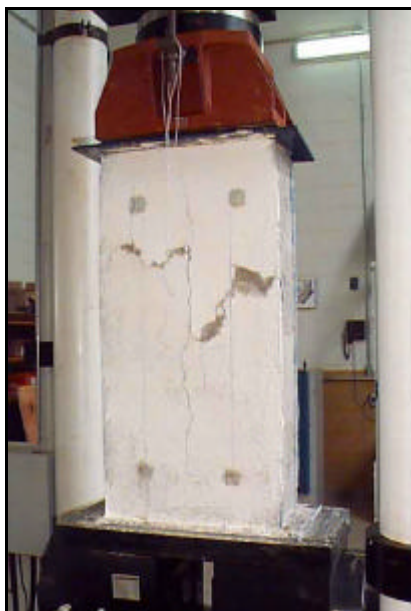
Figura 5.7 - Ruptura da parede P05.
