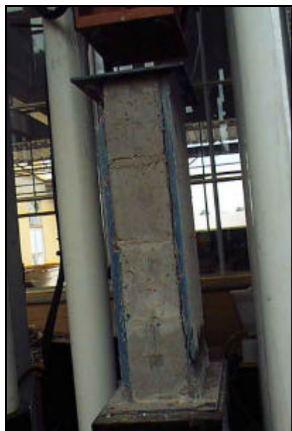
Figura 5.22 - Destacamento do revestimento na parede P15.
