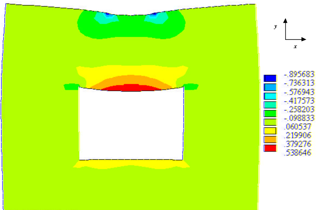
Figura 8.31 - Distribuição das tensões \sigma_x (kN/cm 2 ) – protótipo com revestimento.
