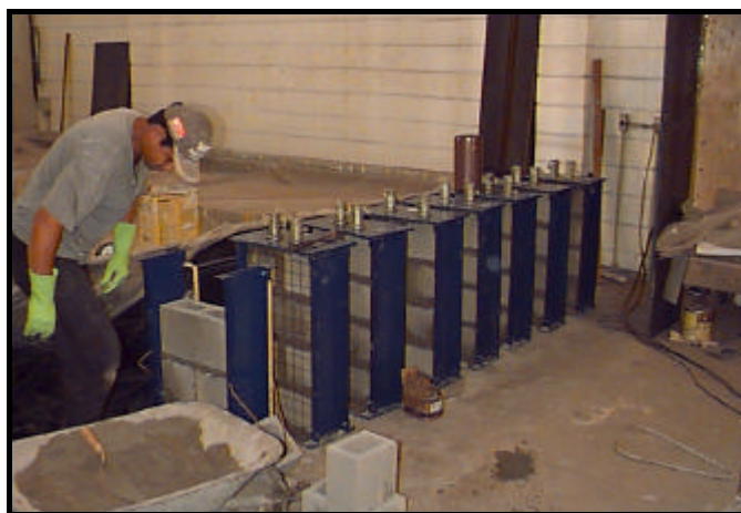
Figura 4.13 - Vista das paredinhas sendo confeccionadas.
