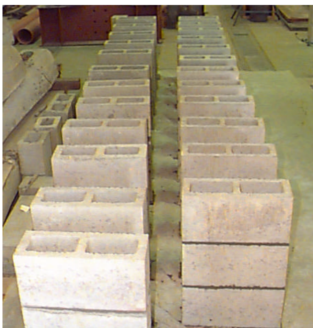
Figura 3.6 – Prismas de 3 blocos (EP1).
