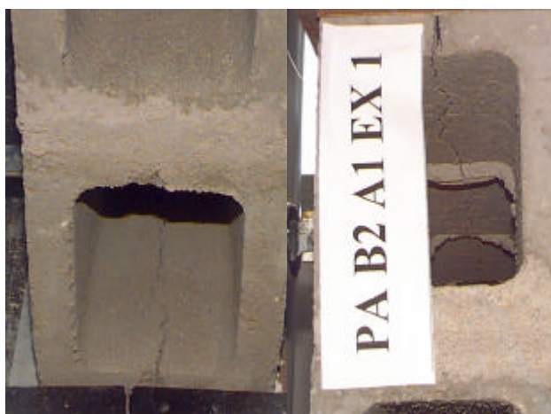
Figura 4.26 – Detalhe da fissuração ao longo dos septos laterais para a paredinha com carregamento na direção X (EF).
