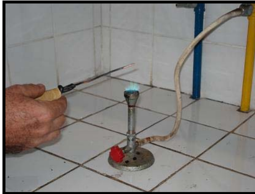
Figura 5.2: Aquecimento do fio de cobre no ensaio de identificação de halogênio.
