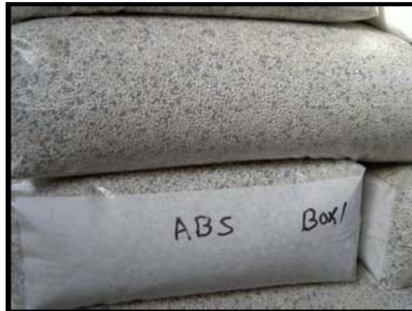
Figura 2.6: Péletes de ABS obtidos por meio do processo de extrusão. Fonte: www1.sac.ac.uk/info/External/Publications/WasteRecycling/Chapter7-SettingupaPlasticsRecyclingBusiness.pdf .
