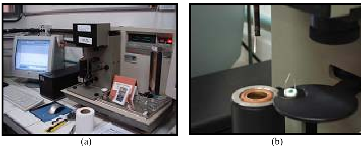
Figura 5.6: Ensaio de TG: (a) equipamento de TG; (b) pesagem da amostra de PEAD verde antes de realizar o ensaio.
