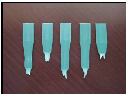
Figura 6.12: Ruptura dos corpos-de-prova de tração de PEAD verde.
