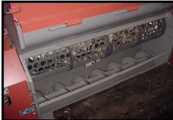
Figura 2.5: Processo de aglutinação. Fonte: www1.sac.ac.uk/info/External/Publications/WasteRecycling/Chapter7-SettingupaPlasticsRecyclingBusiness.pdf .
