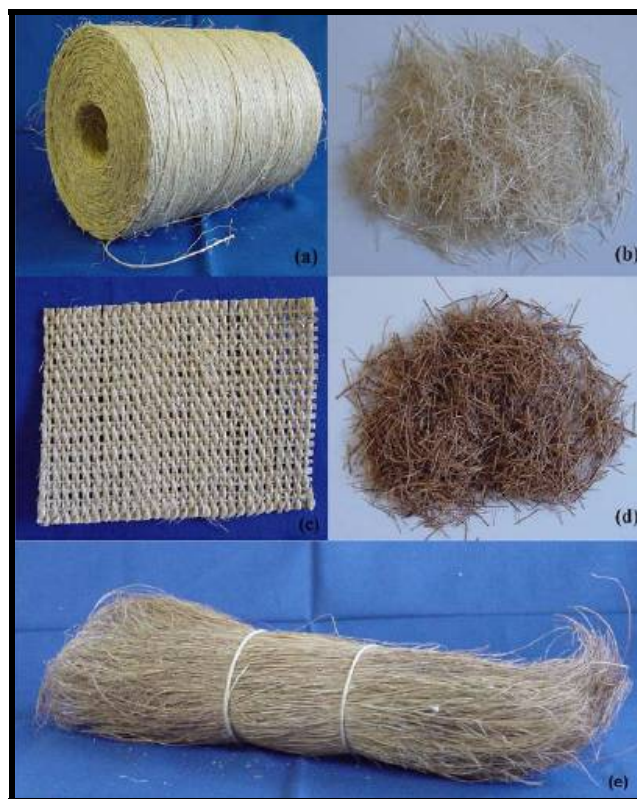
Figura 4.2: Fibras de sisal e de coco nas suas diferentes formas. (a) bobina de fios de sisal; (b) fibras curtas de sisal; (c) tecido de sisal; (d) fibras curtas de coco; (e) fibras de coco penteadas. Fonte: Silva (2003).
