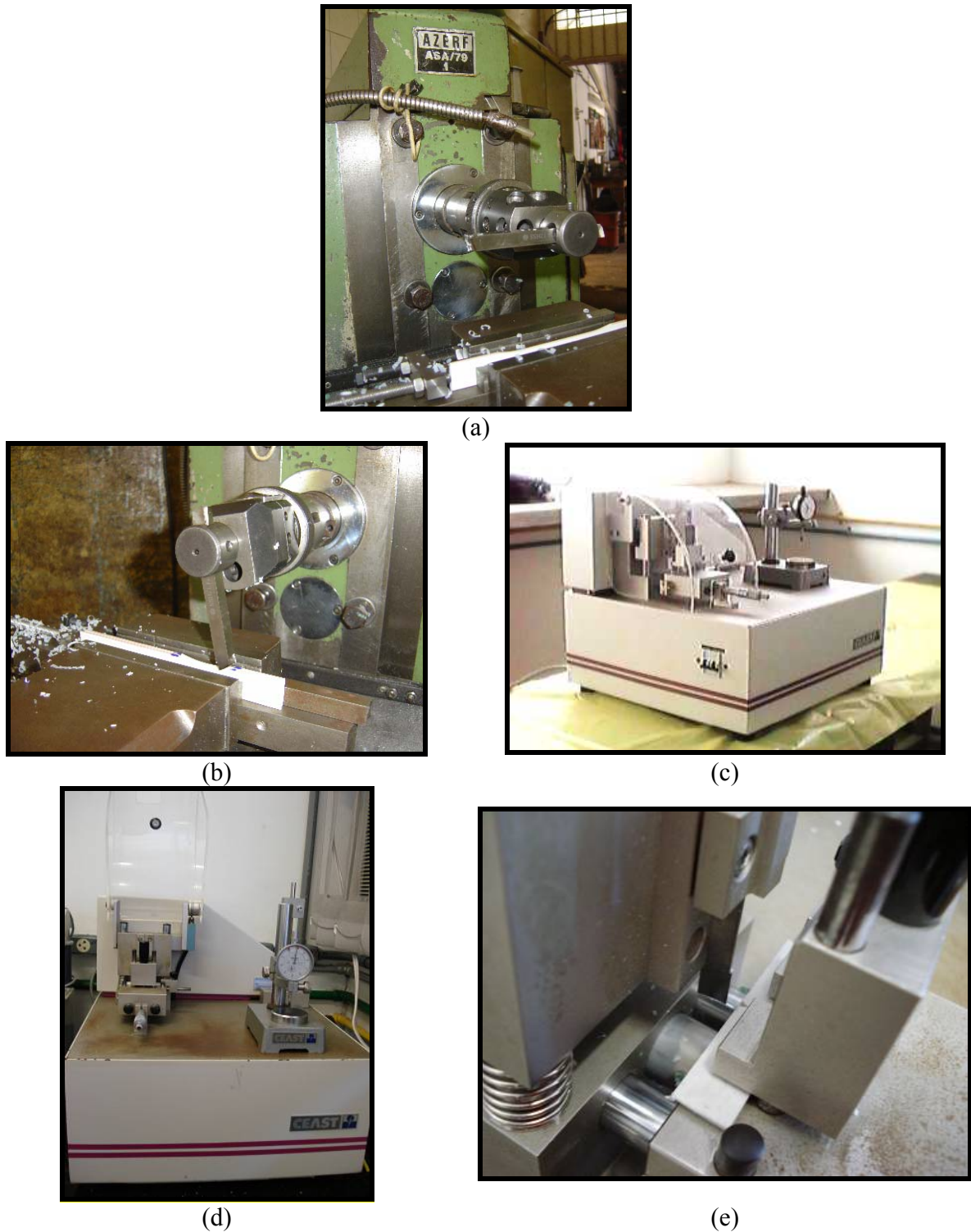
Figura 5.13: Usinagem dos corpos-de-prova: (a) frezadora Universal AZERF ASA/79 1; (b) usinagem do corpo-de-prova de tração; (c), (d) fresa entalhadora para usinagem dos corpos-de-prova de impacto; (e) execução do entalhe no corpo-de-prova.
