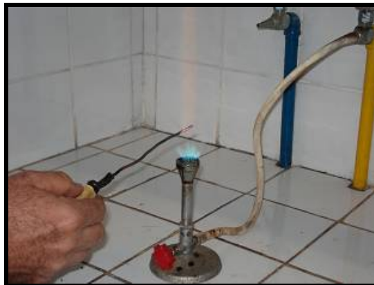
Figura 6.1: Resultado negativo do ensaio de Beilstein para identificação de halogênios.
