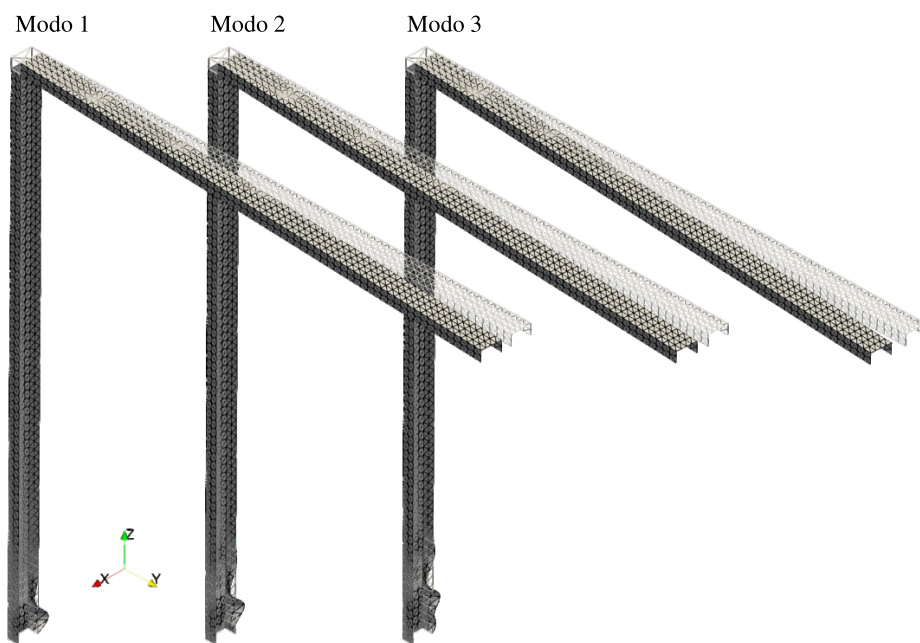
Figura 43 – Primeiros três modos de instabilidade para o problema de torção dominante
