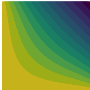
Figura 5.16 – Campos de temperatura para o caso de chapa sem reforço e materiais termicamente linear e não linear, respectivamente.
