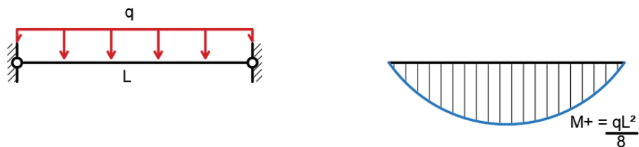
Figura 2-3 – Redistribuição de momento fletor na viga devido a vinculação adotada.
