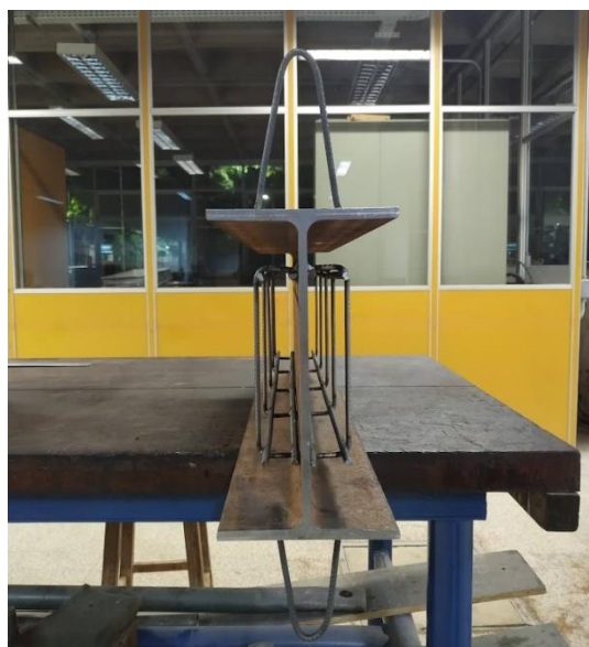
Figura 5.3 – Posicionamento das armaduras no corpo de prova: a) na seção transversal, b) ao longo do comprimento
