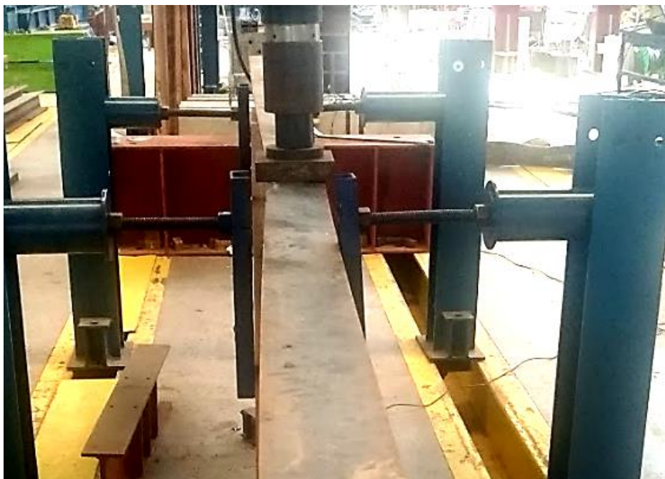
Figura 6.14 – Modo de ruptura da VAço: FLT
