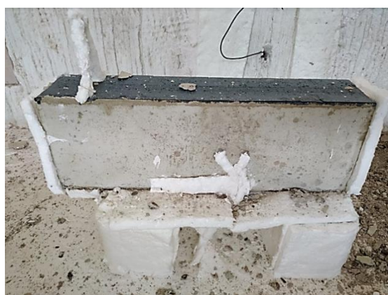
Figura 5.18 – Corpo de prova CP1 pós-fogo: a) lado 01; b) lado 02
