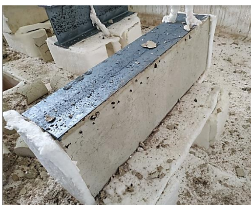
Figura 5.18 – Corpo de prova CP1 pós-fogo: a) lado 01; b) lado 02
