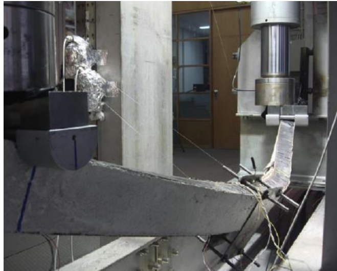
Figura 3.16 – Ensaio de flexão a quatro pontos das VMPR proposto por Piloto et al. (2017)
