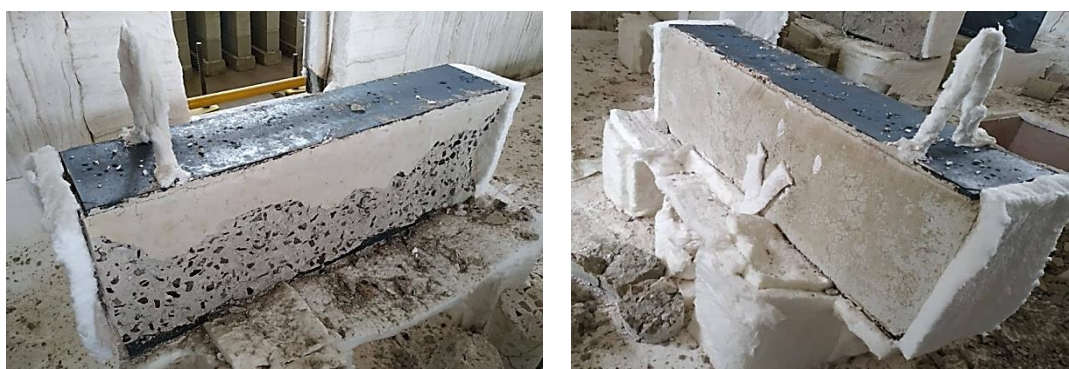
Figura 5.22 – Corpo de prova CP5 pós-fogo: a) lado 01; b) lado 02
