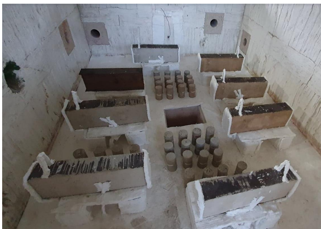
Figura 5.11 – Corpo de prova cilíndricos posicionados no forno
