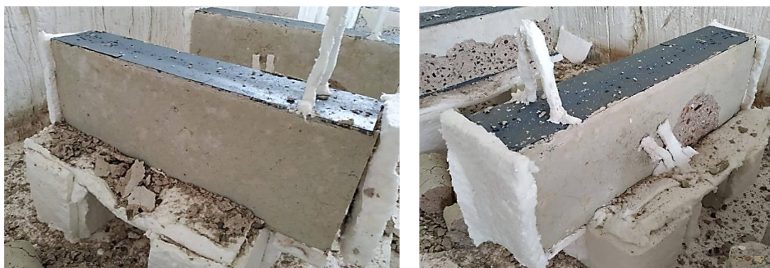
Figura 5.20 – Corpo de prova CP3 pós-fogo: a) lado 01; b) lado 02
