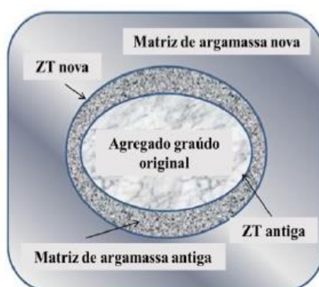
Figura 2.2 – Microestrutura do concreto reciclado
