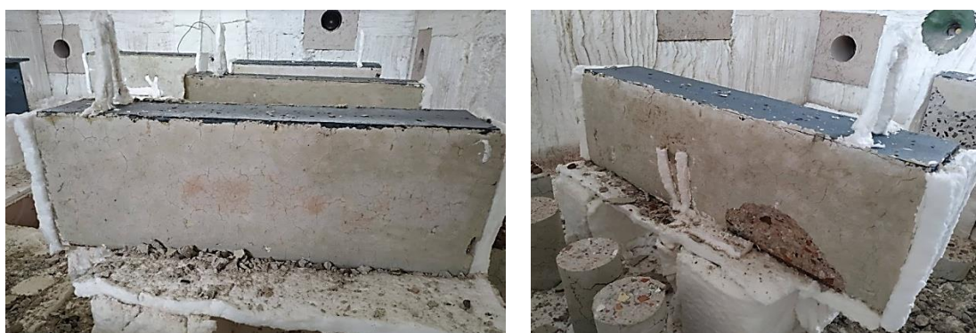
Figura 5.21 – Corpo de prova CP4 pós-fogo: a) lado 01; b) lado 02
