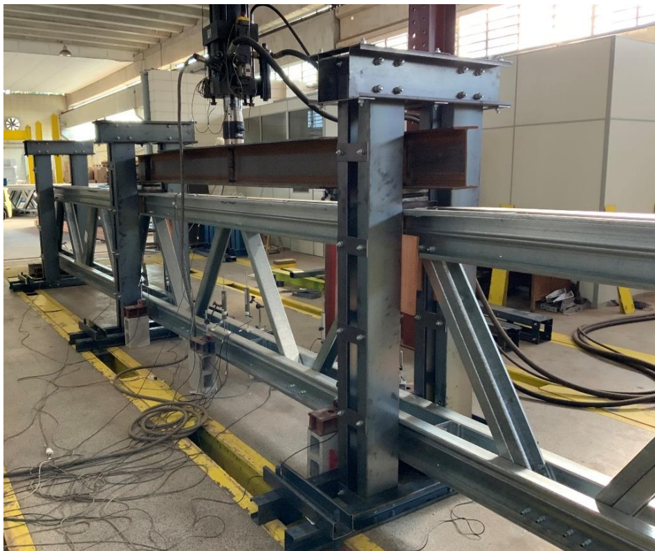
Figura 4.12- Pórticos de travamento e viga de distribuição do carregamento.
