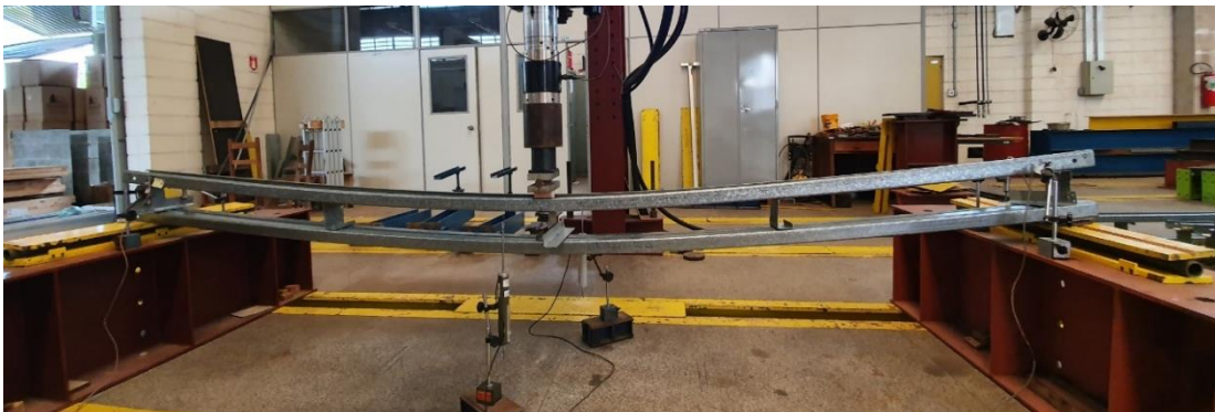
Figura 5.10- Deformada da viga da série UA 360.
