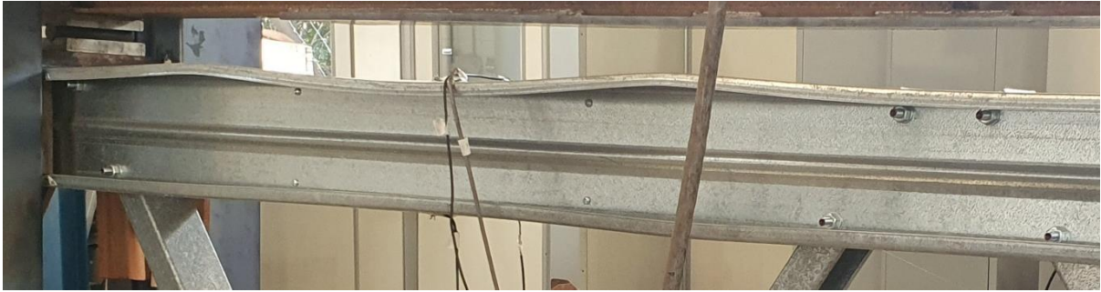
Figura 5.17- Deformada distorcional típica da série 210J360.
