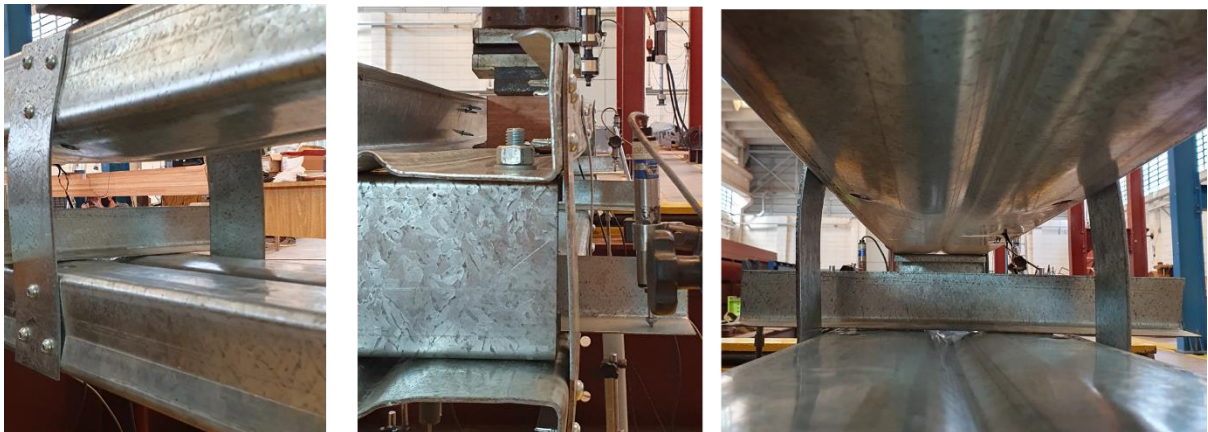
Figura 5.15- Flexão das chapas de ligação.
