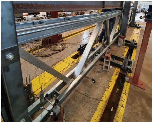
Figura 5.29- Instabilidade por flexão fora do plano para as treliças da série 120J360.
