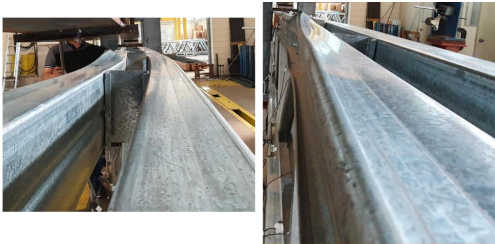
Figura 5.20- Mecanismo plástico associado com o deslocamento fora do plano (210J360.P1).
