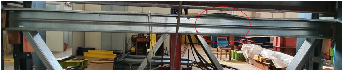
Figura 5.19- Mecanismo plástico formado ao final do ensaio (210J360.P1).
