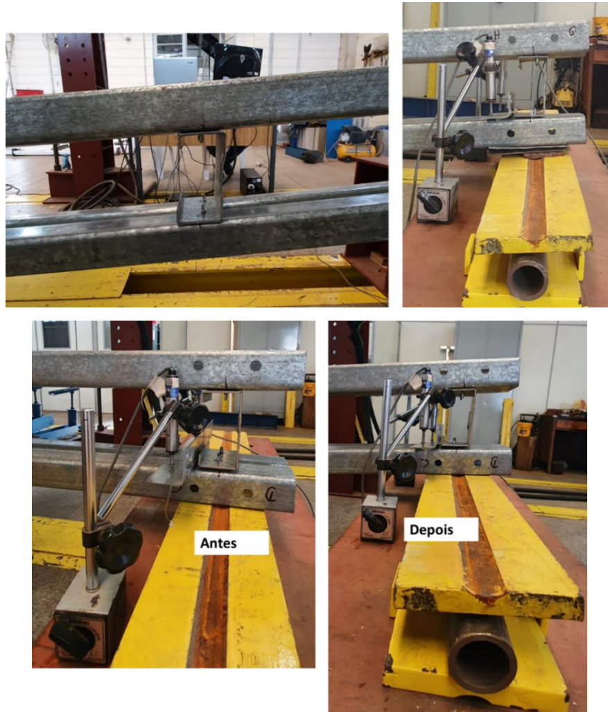
Figura 5.11- Deformada da presilha devido ao efeito da flexão e cortante.
