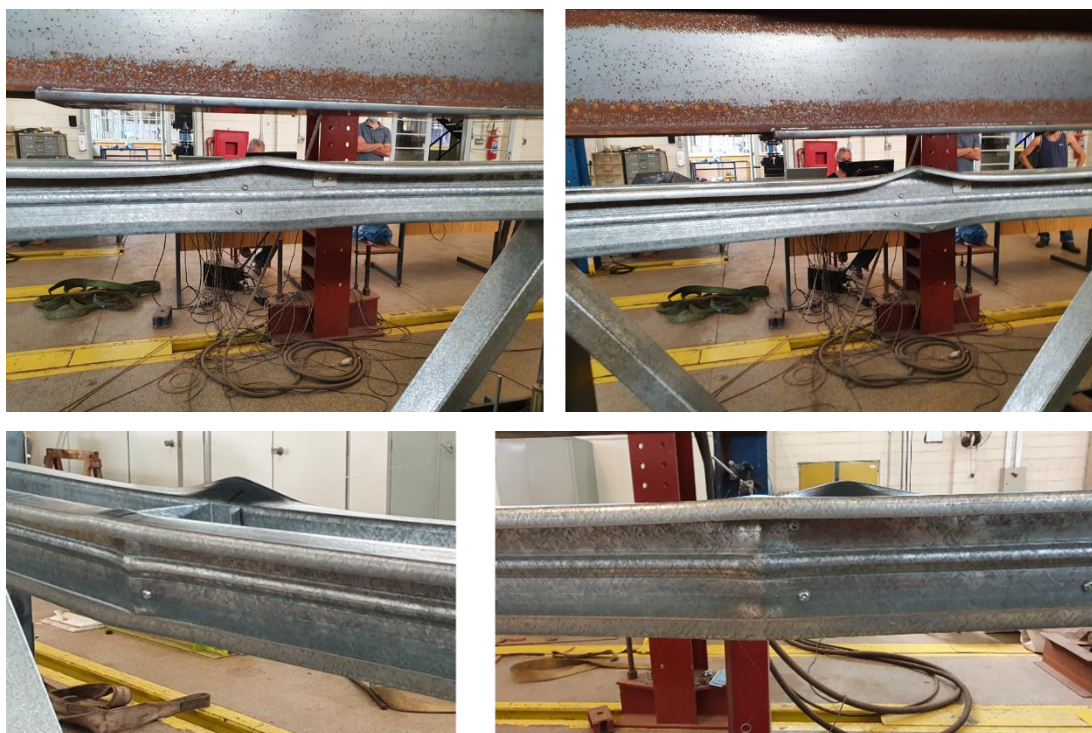
Figura 5.33- Deformada plástica característica para a série 120J180 ao final do ensaio.
