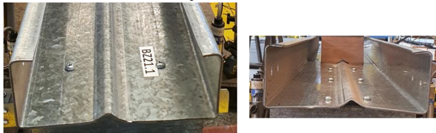
Figura 5.3- Distância entre os parafusos na seção transversal para os protótipos 3A e 5A respectivamente.
